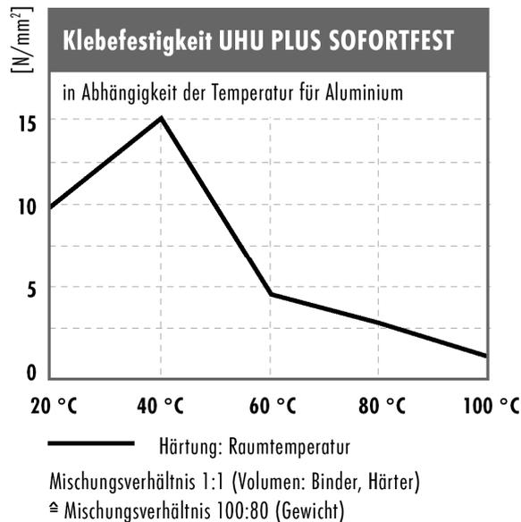
**Durchführung:** Zugscherfestigkeiten in Anlehnung an DIN 53286; vor Prüfung Lagerung 7 Tage bei 20 °C/65% relative Luftfeuchtigkeit; Zwick Prüfmaschine mit Temperierkammer (Prüfgeschwindigkeit: 50mm/min)
